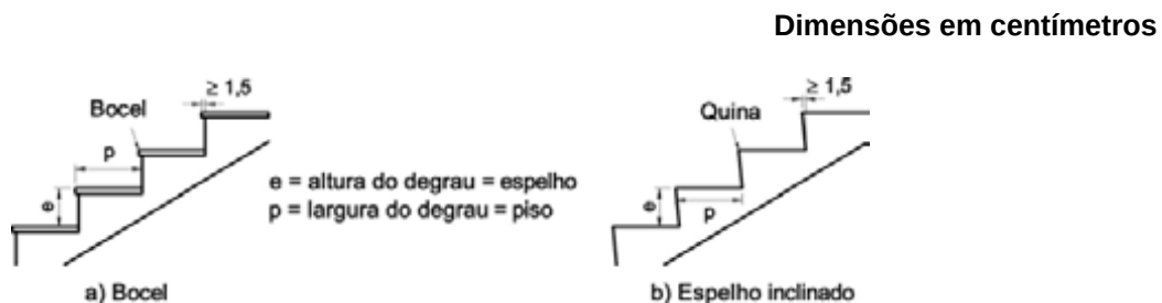
Figura 83 — Altura e largura do degrau
